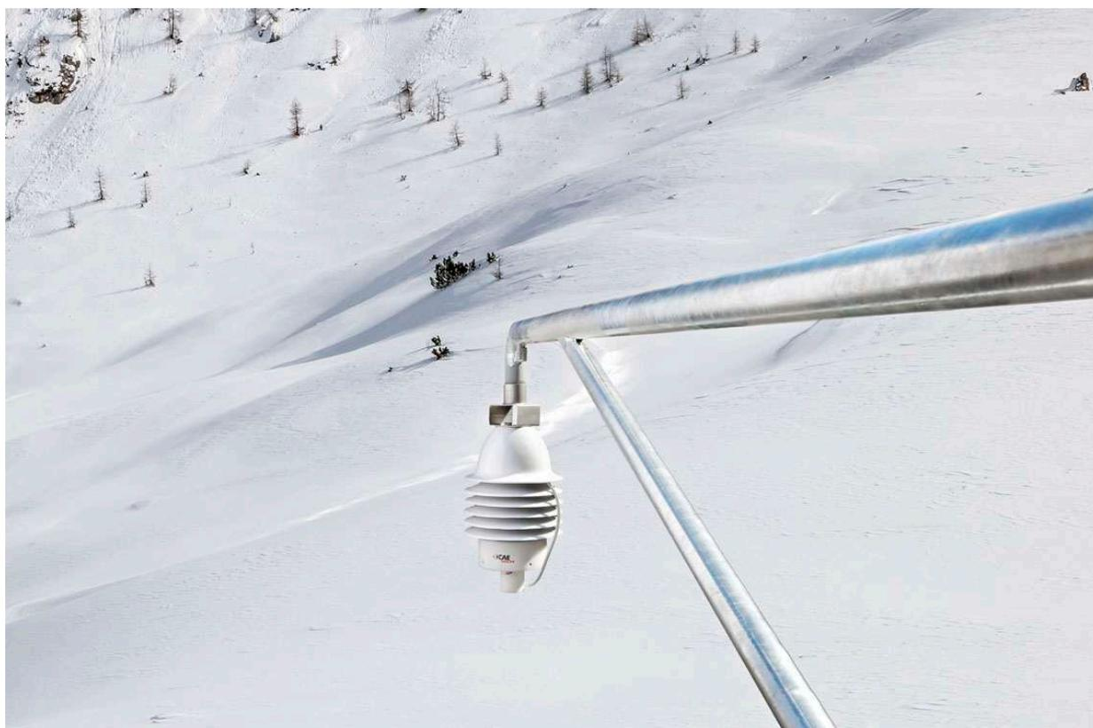
Il sensore è dotato di un real time clock, e di una memoria di registrazione permanente, e comunica con gli altri moduli mediante: bus Caenet, protocollo standard SDI-12 su RS485 e uscita analogica 4-20 mA. Questo consente l'interfacciamento con ogni datalogger.
