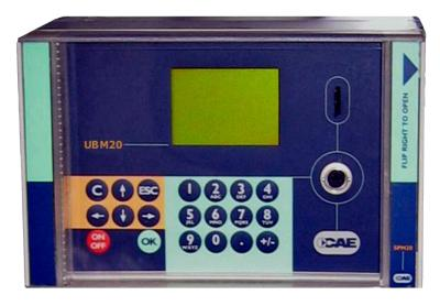
acquisizione UBM20 si occupa del coordinamento e del controllo dei vari moduli connessi, provvedendo a raccoglierne i dati da ciascuno.
