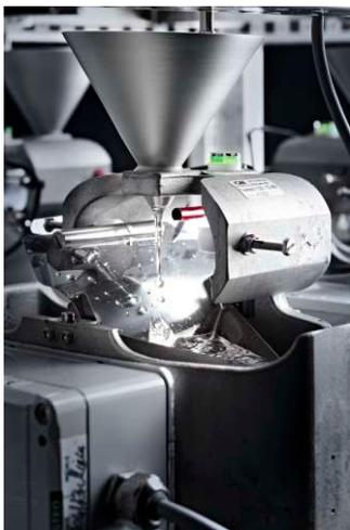
Grazie ad un generatore di riferimento, ovvero un dispositivo che genera un flusso di acqua in maniera estremamente stabile, la macchina permette di conoscere l'esatto tempo di ribaltamento di ogni singola bilancia, consentendo quindi un perfetto bilanciamento delle due vaschette.
