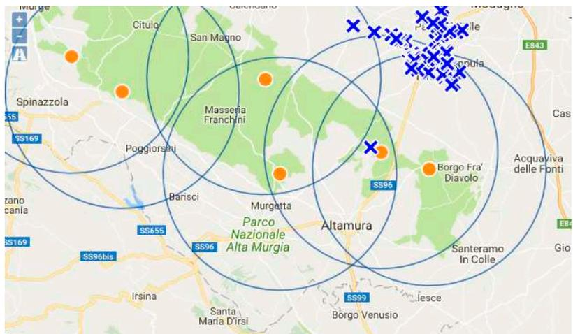
Después de una alarma, el software, equipado con algoritmo de georreferenciación, en función de la posición conocida del punto de observación, **proyecta las coordenadas 2D del punto de cebado detectado por la termocámara en un DTM** (Digital Terrain Model), obteniendo el posicionamiento del punto caliente en términos de latitud y longitud con un margen mínimo de error.
