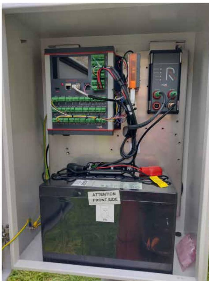
RÆVO è in grado di interagire con dispositivi e applicazioni di diversa natura, infatti, è in grado di supportare moderni protocolli standard **UDP/IP** ed è predisposta per il vecchio Modbus RTU.
