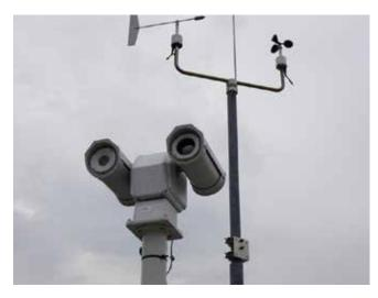
parametri meteorologici principali e una combinazione di termocamere, videocamere e procedure software da utilizzare presso un Centro di controllo e supervisione.
