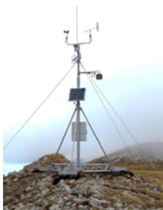
con struttura in acciaio e alluminio in modo da risultare leggera per facilitare i lavori in contesti non agevoli e allo
