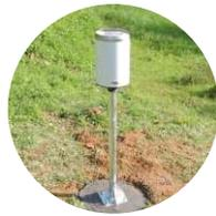
Todos estos son suministros de última generación, de hecho las **estaciones pluviométricas autónomas** consistir en **PG4i** equipados con **registrador de datos y módulo 3G integrados**. PG4i es un pluviómetro autónomo que realiza las actividades de una pluviométrica completa permitiendo registrar y enviar a la Central o al servidor **FTP**, además de los datos de **intensidad y acumulación de lluvia**, también la información de **diagnóstico**.
