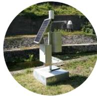
Las **estaciones pluviométricas con calentador** están equipadas con **PG2R**, un pluviómetro diseñado para minimizar el consumo de energía, lo que permite ser utilizado en estaciones alimentadas exclusivamente por panel solar y batería.
